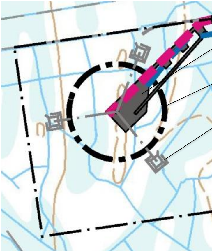
Kuva 3. Harusten perustukset sijoittuvat nostoalueen ulkopuolelle.
